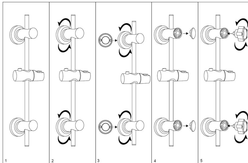
**Schritt 1-3:** Drehen Sie die Abdeckung der Dichtung nach links und nehmen Sie die Dichtung heraus.
