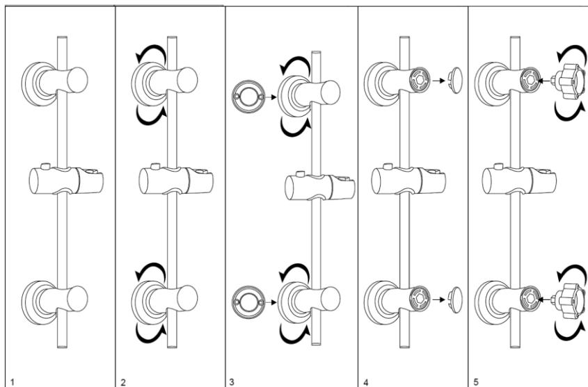
**Stap 1-3:** Draai de afdekking van de afdichting naar links en verwijder de afdichting.
