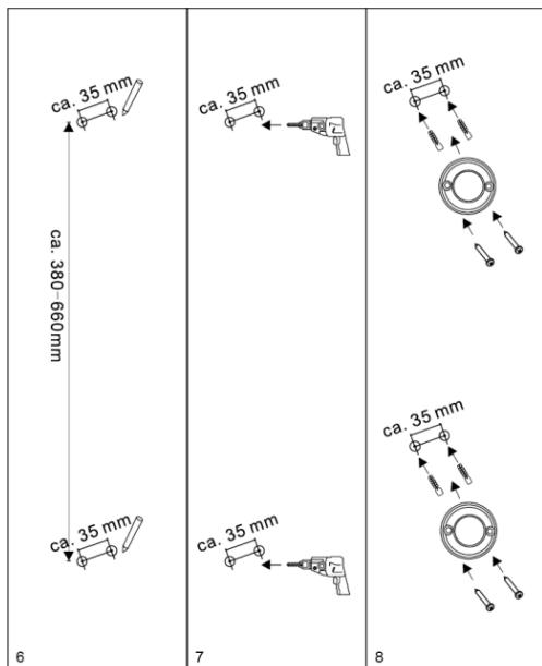
**Option d'installation 1 : Fixation avec vis**
