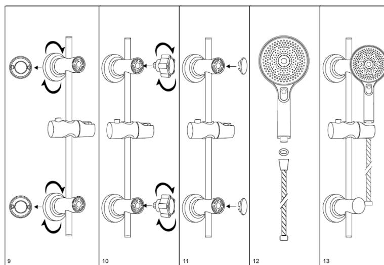
**Schritt 12-13:** Setzen Sie die mitgelieferten Dichtung C an die Enden des Brauseschlauchs auf. Setzen Sie dann die Handbrause auf die Gleitschiene.
